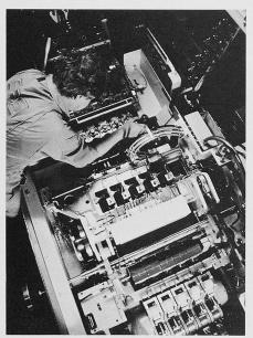
Bild 3. Die Mehrstufen-Kaltumformpresstechnik mit Nachoperationen
