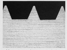
Bild 4. a) gewalztes Gewinde b) geschnittenes Gewinde
