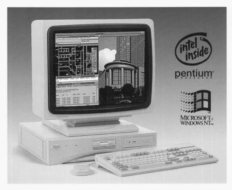
Die TD3 arbeitet mit dem 90 MHz schnellen Pentium P54C-Mikroprozessor. Der 17"- oder wahlweise 20"-Farbmonitor hat eine sehr hohe Auflösung von 1280 x 1024 Bildpunkten. Die standardmässige Local Bus-Grafik mit G90-Beschleuniger erlaubt Einzel- oder Doppelbildschirm-Konfiguration. Der RAM-Hauptspeicher geht von 16 bis 192 MByte und bietet somit Platz für praktisch jede Anwendung.
