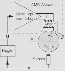
Grundprinzip der aktiven elektromagnetischen Lagerung
