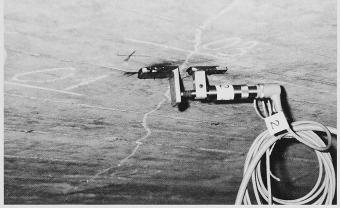
Bild 4. Messung der Rissbewegung unter Verkehr mt induktiven Wegaufnehmern durch die EMPA
