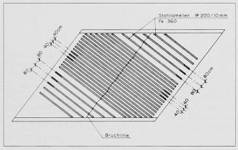
Bild 2. Lamellenanordnung und Bruchlinie
