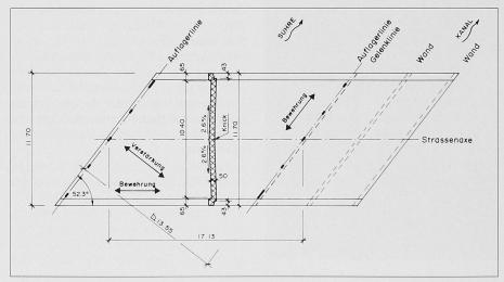
Bild 1. Objekt 208a, Suhrebrücke: Abmessungen der Brückenplatte
