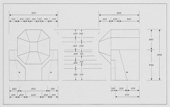
Bild 16. Detailmasse der Blöcke
