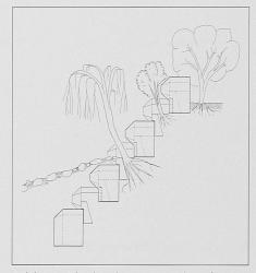
Bild 15. Blockreihen mit Lücken für verbesserten Bewuchs
