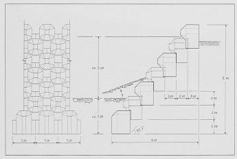
Bild 10. Ansicht und Querschnitt des «synthetischen» Blockwurfes
