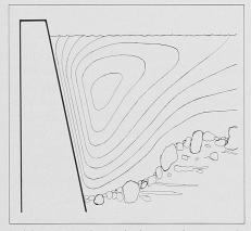
Bild 3. Geschwindigkeit (schematisch) und Auskolkung mit einer Wandrauhigkeit k<sub>2</sub>, die viel kleiner ist als jene des Flussgrundes k<sub>1</sub>
