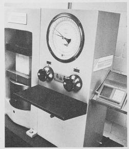
Durch den Anschluss eines Wigameter-Anzeigegerätes (rechts) können ältere Druckprüfmaschinen hochgerüstet werden
