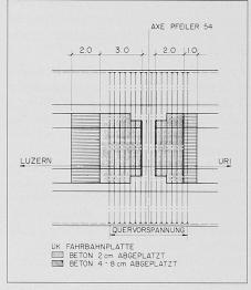
Bild 10. Ist-Zustand nach Brand UK Fahrbahnplatte
