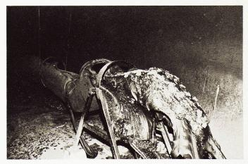
Bild 5. Brückenentwässerung Hauptleitung verbrannt und geschmolzen
