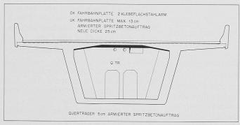
Bild 13. Sanierung Brandabschnitt
