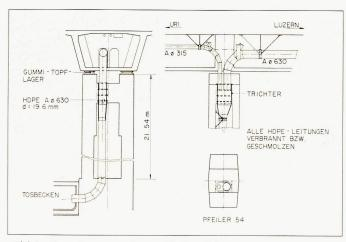
Bild 1. Entwässerung beim Pfeiler 54
