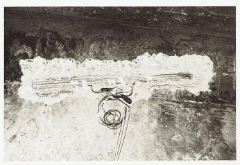
Bild 12. Prüfung Längsvorspannung an Ort
