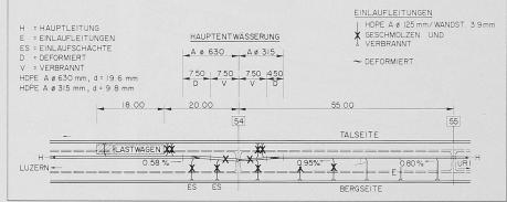
Bild 7. Brandschäden am Entwässerungssystem
