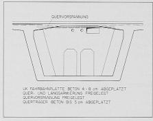
Bild 9. Ist-Zustand nach Brand im Querschnitt
