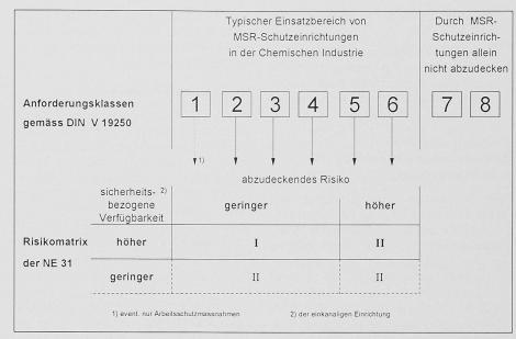
Bild 10. Anforderungsklassen gemäss DIN V 19250 und Risikomatrix der NAMUR-Empfehlung NE 31
