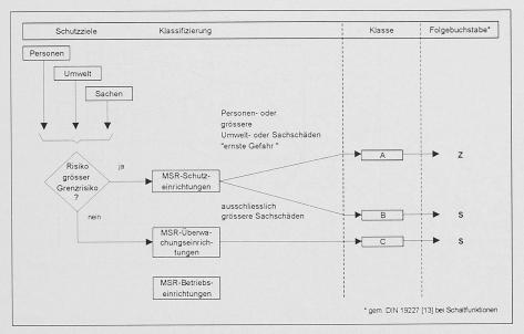
Bild 4. Klassifizierung von MSR-Einrichtungen
