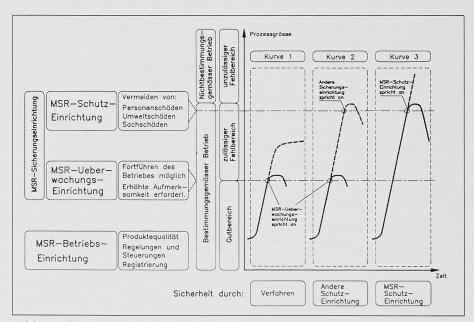
Bild 3. Schematische Darstellung der Wirkungsweise von MSR-Einrichtungen
