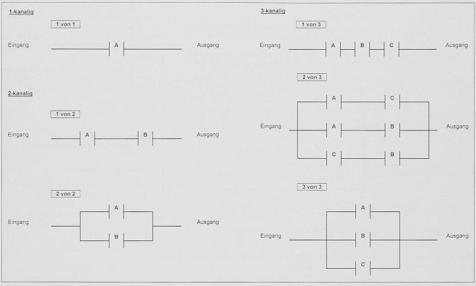
Bild 6. Grundschaltungen mittels m-von-n-Bewertung
