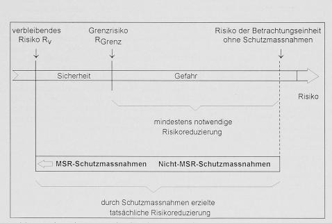
Bild 1. Risikoreduzierung durch Schutzmassnahmen
