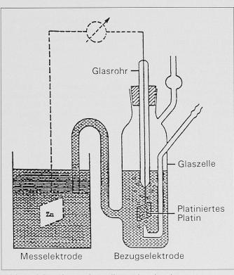
Bild 1. Elektrochemische Zelle (Leclanché-Element)
