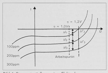
Bild 4. Strompotentialkurve einer Elektrode
