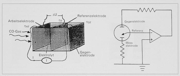
Bild 8. Potentiostatische Schaltung eines elektromechanischen Gassensors
