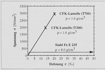
Bild 2. Spannungs-Dehnungs-Diagramme von CFK-Lamellen mit Fasern T300 und T700 (Faservolumengehalt ≈ 70 %) im Vergleich zum Stahl Fe E 235
