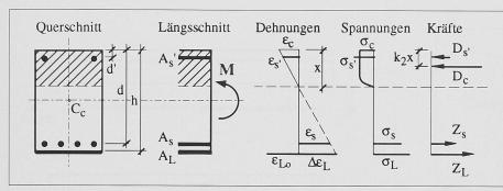
Bild 5. Rechteckquerschnitt: Berechnung des Bruchmomentes
