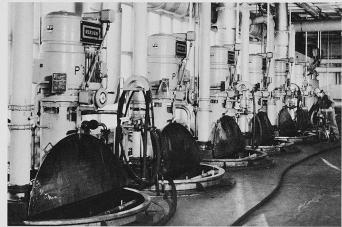
Bild 3. Farbstoffchemie, Syntheseanlage der zweiten Generation
