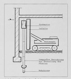
Bild 1. Kleinbohrpfahl
