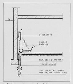
Bild 3. Injektionsbohrpfahl
