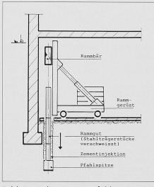
Bild 4. Injektionsrammpfahl
