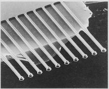
Experimentelle Anordnung von 10 mikrotechnischen Auslegern aus Silizium, die vier Zehntelsmillimeter über die Kante hinausragen. Wissenschaftler verwenden solche Elemente als chemische Sensoren mit bisher unerreichter Empfindlichkeit. Die abgebildete Struktur ist vom Institut für Mikrotechnologie an der Universität Neuenburg hergestellt worden (Bild: IBM)
