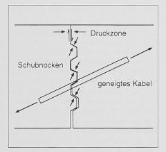
Bild 2. Aufnahme der Querkraft in Segmentfuge
