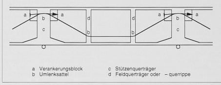
Bild 1. Kabelführung im Brückenkasten
