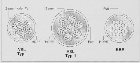
Bild 3. Kabelquerschnitte [5, 6]
