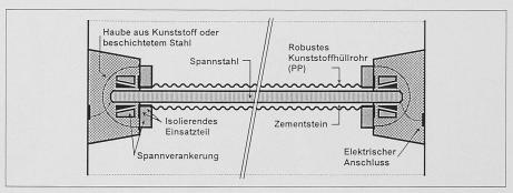
Bild 6. Elektrisch isoliertes Spannglied – schematische Darstellung
