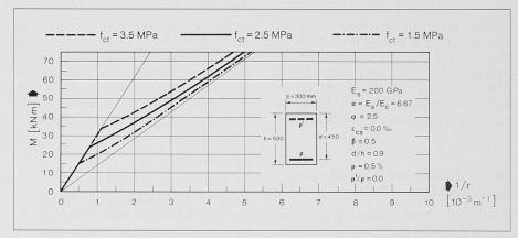
Bild 8. Momenten-Krümmungs-Beziehungen für  $f_{ct} = 1,5; 2,5; 3,5 \text{ N/mm}^2 \text{ (MPa)}$
