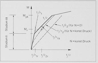
Bild 2. Momenten-Krümmungs-Beziehung bei Biegung mit konstanter Axialkraft N
