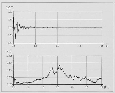
Bild 4. Beschleunigung und Fourier-Amplitudenspektrum aus dem Sandsackversuch am Sprungturm mit frei schwingendem Tilger
