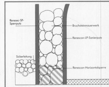
Die Reneson-Horizontalsperrre verhindert das Aufsteigen der Feuchtigkeit. Das Mauerwerk trocknet aus.
