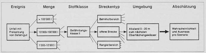
Bild 5. Ausschnitt aus einem Szenarienbaum für die Abschätzung der Gefährdung von Oberflächengewässern
