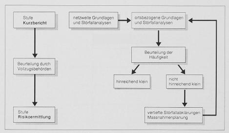
Bild 1. Verfahren gemäss Störfallverordnung für die SBB
