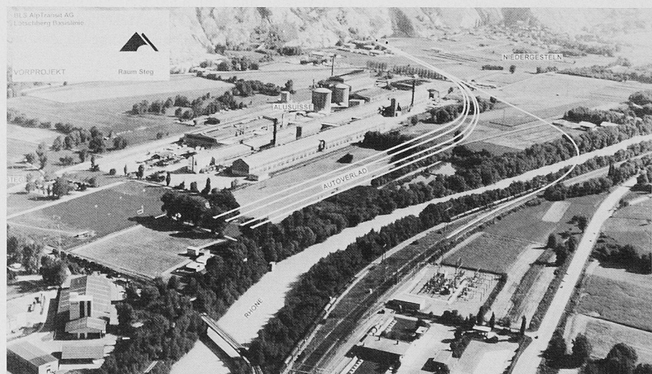
Bild 2. Aus dem Lötschberg-Vorprojekt. Anlagen im Raum Steg: Tunnelportal, Autoverladestation und direkte Verbindung Mittelwallis
