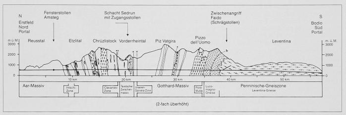
Bild 1. Geologisches Längenprofil des 57 km langen Gotthard-Basistunnels. Zwischenangriffe erfolgen in Amsteg UR, Sedrun GR und Faido TI
