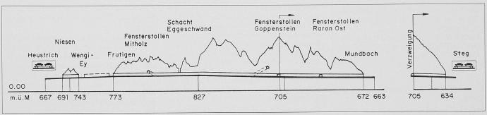
Bild 3. Längenprofil der Lötschberg-Basislinie (Variante «Gesamtausbau») mit Verzweigung nach Steg
