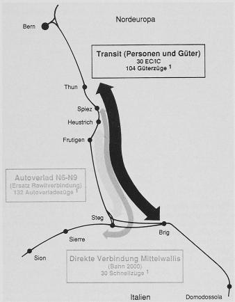
Bild 2. Die drei Funktionen der Lötschberg-Basislinie (¹Kapazität der Linie, Anzahl Züge pro Tag in beiden Richtungen zusammen)
