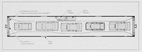
Bild 3. Pw-Transportwaggon mit Brandabschottungen an den Wagenenden und Möglichkeit zum Entkuppeln vom Waggoninnern aus
