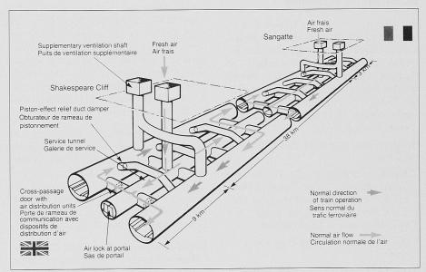
Bild 6. Lüftungssystem für Kanaltunnel mit Überdruck im Wartungstunnel
