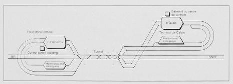
Bild 7. Terminals mit Ausweichgleisen für Züge aus den Tunnels bei Brandbekämpfung und Überleitstellen für den Gleiswechsel von einem zum anderen Eisenbahntunnel
