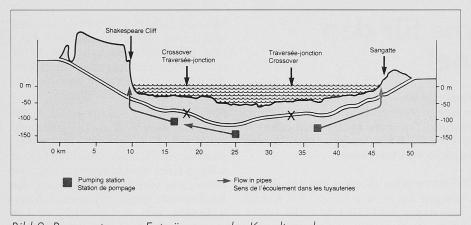
Bild 2. Pumpsystem zur Entwässerung des Kanaltunnels
