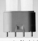
OSRAM DULUX T, DULUX D und DULUX S 2-Stift-Stecksockel für KVG 4-Stift-Stecksockel S/E, D/E,T/E-Versionen für EVG
