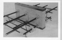
Der EURO-patentierte, EMPA-geprüfte, in der Schweiz meistverwendete kraftschlüssige Normkonstruktions-Kragplattenanschluss aus hochwertigem Armierungsstahl S 500 mit dazwischenliegender Wärmedämmung aus Mineralwolle • ein statisch klares System • korrosionssicher • bruchsicher • einbausicher • brandsicher.
