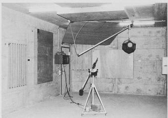
Bild 2. Messeinrichtungen im Luftschallprüfstand
