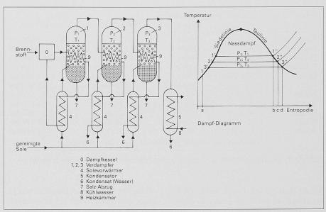
Bild 4. Prinzip einer Mehrfach-Verdampfungsanlage
