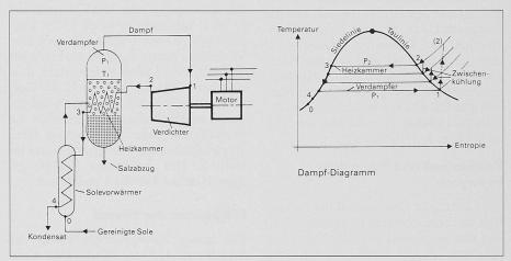
Bild 5. Prinzip einer Thermokompressions-Anlage
