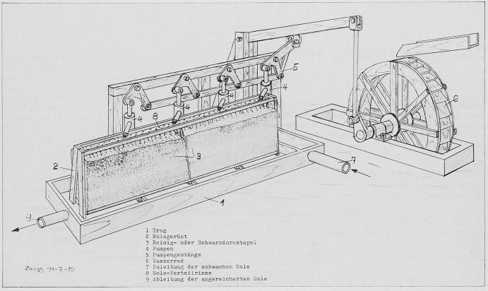
Bild 2. Prinzip eines Gradierwerkes zur Anreicherung schwacher Sole
