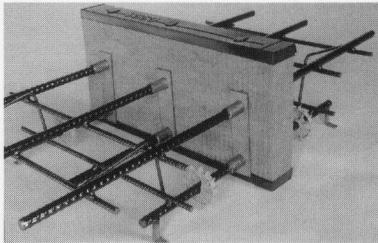
**EgcoBox** Der EURO-patentierte, EMPA-geprüfte, in der Schweiz meistverwendete kraftschlüssige Normkonstruktions-Kragplattenanschluss aus hochwertigem Armierungsstahl S 500 mit dazwischenliegender Wärmedämmung aus Mineralwolle • ein statisch klares System • korrosionssicher • bruchsicher • einbausicher • brandsicher.
