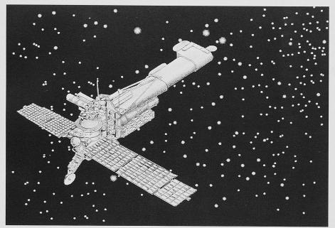
Darstellung des Satelliten Spectrum Röntgen-Gamma, wie er 1995 auf eine Erdumlaufbahn geschickt werden soll. Vorne die ausgebreiteten Solarzellen-Panels. Euvita (Extreme Ultraviolet Imaging Telescope Array) wird auf dem vorderen Teil des Hauptträgers so montiert sein, dass ein freier Blick ins Weltall gewährleistet ist (Bild: PSI/Cedos)
