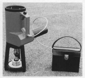
Haftzugprüfgerät F 10 D "EASY M" 10 kN GKL. I Antrieb mit Servomotor – Stromversorgung durch Akku
