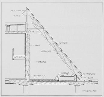
Bild 5. Der Schnitt durch die Promenade zeigt die Massnahmen für die passive Solarenergienutzung, die trotz des riesigen Schrägglasdaches ein sehr angenehmes Raumklima ermöglichen
