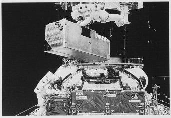
Kathryn Thornton hebt die Korrekturoptik Costar, eine Box von der Grösse einer Telefonzelle, aus dem Container in der Ladebucht. Mit Hilfe des Manipulatorarms führt Claude Nicollier die Astronautin zur Einbauöffnung am Teleskop. Links unten ist Thomas Akers zu erkennen
