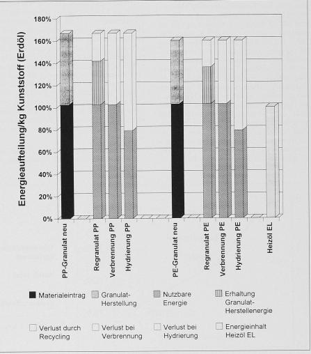
Bild 1. Nutzbare Energie aus gebrauchtem Polypropylen (PP) und Polyäthylen (PE) im Vergleich zu Heizöl EL
