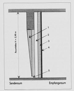
Vertikalschnitt durch Prüföffnung mit Dachmodell
