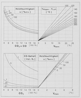
Bild 2. Nomogramm zur Bestimmung des feuerungstechnischen Wirkungsgrads, wobei
