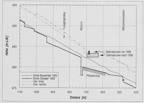
Bild 2. Längenprofil der Saltina im Bereich der Saltinabrücke. Im Rahmen des Brückenneubaus von 1958 wurde die Flussohle lokal abgesenkt und künstlich gepflästert. Im Bild ebenfalls gezeigt ist die Sohlenlage von 1923
