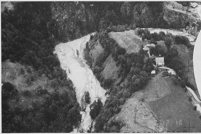
Bild 3. Der untere Teil der Schlüsselstrecke im Grindji. Unter der am rechten Bildrand noch erkennbaren Nationalstrassenbrücke befindet sich die Geschieberückhaltesperre. Blick in Fließrichtung. (Foto P. Thee, Eidg. Forschungsanstalt für Wald, Schnee und Landschaft, Birmensdorf)
