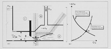
Bild 4. a) Systematische Darstellung eines Grundablasses mit den Hauptparametern und den Einflussbereichen für die Belüftung des Austrittstrahls (vgl. Text); b) Funktionsprinzip der Grundablass-Belüftung, W = Arbeitspunkt der Luftaufnahme
