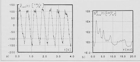
Bild 11. Schwingungszustand,  $s_0 = 1.6$  m,  $s_u = 0.7$  m; a) Zeitreihe der vertikalen Beschleunigung  $\ddot{z}_{ou}$  (t) in der Mitte der oberen Schützentafel und b) entsprechendes Leistungsspektrum  $S_{z_m}^2$  (f)
