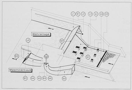
Bild 2. Stellen möglicher Schäden infolge fluiddynamischer Belastungen an Flusskraftwerken. L = Lufteintrag, K = Kavitation, D = dynamische Druckschwankungen, S = Schwingungen (vgl. Tabelle 1)
