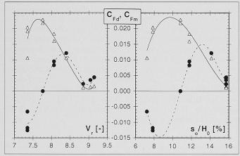
Bild 9. Anfachungskoeffizienten (•) C<sub>Fm</sub> und (Δ) C<sub>Fd</sub> für die vertikale Starrkörperbewegung z(t): a) in Funktion der reduzierten Geschwindigkeit V<sub>r</sub>, b) in Funktion der relativen Öffnung der oberen Schütze s<sub>0</sub>/H<sub>0</sub>
