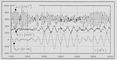
Bild 8. Zeitreihen der vertikalen und horizontalen Beschleunigungen ( $\ddot{z}(t)$  und  $\ddot{x}(t)$ ) auf der unteren Schützentafel sowie der Kraft in einem Strang der Aufzugsketten  $F_c(t)$ . Die Kopplung zwischen z(t) und x(t) ist in den Beschleunigungssignalen deutlich zu sehen
