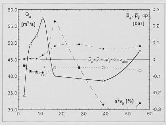
Bild 6. Naturmessungen in der Mischungszone des Grundablasses Curnera: ( $\Delta$ ) Lufteintrag  $Q_{\circ}$ , ( $\circ$ ) mittlerer Luftdruck  $\bar{p}_{o'}$  (ullet) mittlerer Wasserdruck  $\bar{p}_i$  und (ullet) Standardabweichung des Wasserdrucks σp'; in Funktion der relativen Schützenöffnung s/so
