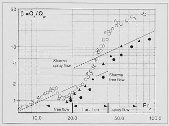
Bild 5. Luftgehalt β der Strömung in Funktion der Froude-Zahl Fr<sub>c</sub> an der Vena contracta. Daten von Curnera (verbesserte Belüftung): ( $\bullet$ )  $H_0 = 100.6$  m, ( $\blacktriangle$ )  $H_0 = 153$  m; Daten von Panix: ( $\triangle$ )  $H_0 = 40$  m, ( $\square$ )  $H_0 = 45$  m, ( $\bigcirc$ )  $H_0 = 50$  m. (-) Berechnungen nach Sharma
