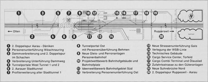
Bild 2. Aus- und Umbau Bahnhof Aarau, schematische Übersicht
