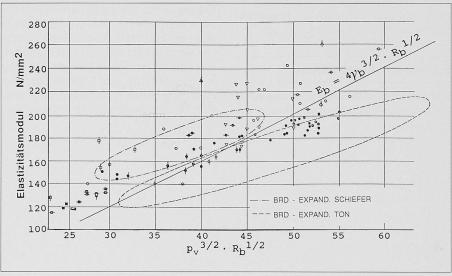
Bild 2. Abhängigkeit zwischen Elastizitätsmodul, Rohdichte und Würfeldruckfestigkeit
