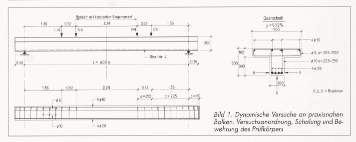
folgten mit einem Handmikroskop von +-2/100 mm Ablesegenauigkeit. Im weiteren wurden vertikale Verschiebungen, Stahldehnungen und Betonstauchungen ermittelt, vor allem im mittleren Bereich mit konstantem Biegemoment. Zudem wurden allfällige Schlupfbewegungen an den Balkenenden überprüft.
