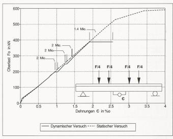
Bild 4. Last-Verformungs-Diagramm für die Stahldehnungen in Feldmitte. Zum Vergleich ist das entsprechende Diagramm des statischen Versuchs ebenfalls dargestellt. Demnach war der Einfluss der dynamischen Beanspruchung ebenfalls gering
