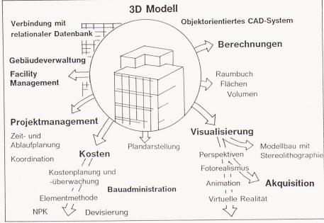
Bild 10. Das 3D-CAD-Modell bildet künftig die Basis für sämtliche Aufgaben für Planer und Verwalter von Bauobjekten. Der SL-Modellbau ist eine Möglichkeit unter vielen der direkten Ausnützung von leistungsfähigen 3D-CAD-Systemen
