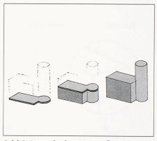
Bild 5. Der schichtweise Aufbau des Modells. Die Schichtdicke muss dem Detaillierungsgrad und dem gewählten Material angepasst werden. Schichtdicke: 0,15–0,8 mm
