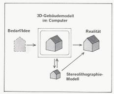
Bild 12. Vom Bedarf, der Idee zum realen Objekt. Was sich hier gegenüber dem traditionellen Vorgehen ändert, ist die Tatsache, dass das Stereolithographie-Modell den Abguss des jeweiligen Planungszustandes darstellt. Das 3D-Modell ist im Normalfall genau der Zustand, der für die Realität vorgesehen ist. In dem Sinne ist das SL-Modell wirklichkeitsgetreuer
