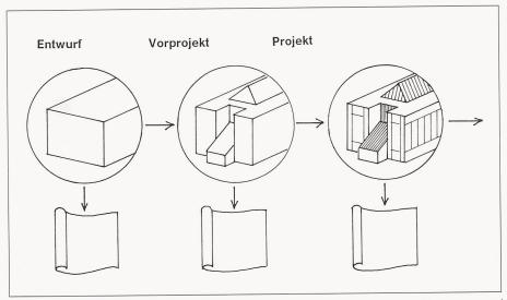
Bild 8. Im 3D-CAD-System ist die Realität in einem bestimmten Detaillierungsgrad abgebildet. Je früher im Planungsprozess man sich befindet, desto gröber sind die jeweiligen Bauteile und Elemente
