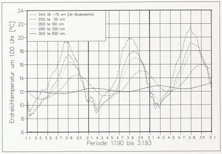
Bild 8. Verlauf der Erdreichtemperaturen in unterschiedlichen Tiefen über und unterhalb der Rohrmitte des Rohres Nr. 32 (1990–1992)
