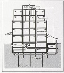
Bild 4. Prinzipschema der Ersatzluftanlage mit Lufterdregister
