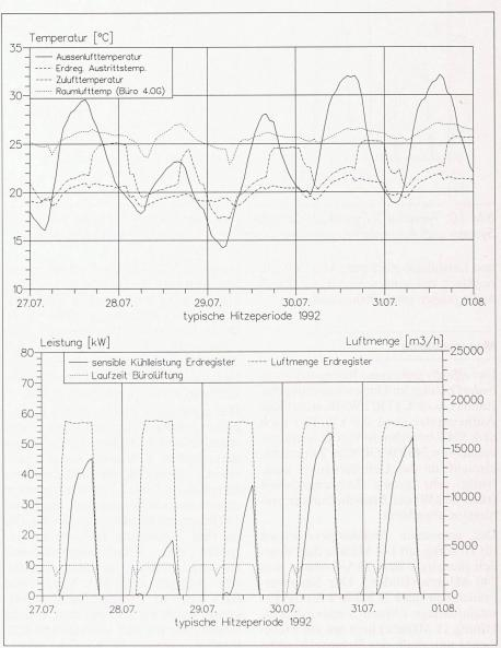
Bild 9. Typische 5-Tages-Hitzeperiode im Sommer 1992 mit Darstellung der System- und Aussenluftemperaturen, Luftmengen und Erdregisterleistungen
