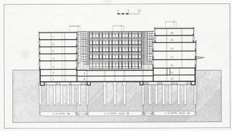
Bild 3. Schnitt und Fassadenansicht «Schwerzenbacherhof»
