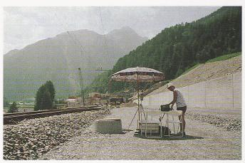
Bild 12. Lärm-Messtation auf dem Gelände des zukünftigen Verladebahnhofs Susch-Lavin (Photo: I. Sommer, BfÖ)
