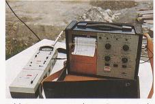
Bild 9. Die verwendeten Geräte. Links der Pegelmesser, rechts der Pegelschreiber (Photo: I. Sommer, BfÖ)
