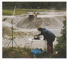
Bild 8. Eine Lärm-Messstation am Rande der ehemaligen Kiesgrube Mulignè, Zernez (Photo: I. Sommer, BfÖ)
