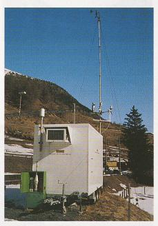
Bild 2. Luftschadstoff-Messwagen mit Meteomast (Photo: I. Sommer, BfÖ)
