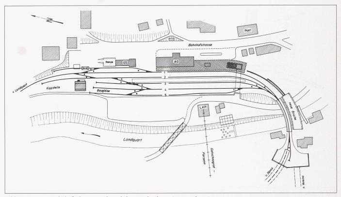
Bild 5. Situation Bahnhof Klosters während des Brückenbaus (1. Bauphase)
