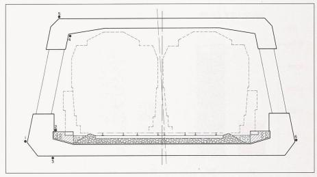
Bild 3. Installierte Temperaturfühler 1–6 (Ing.büro H. Rigendinger)
