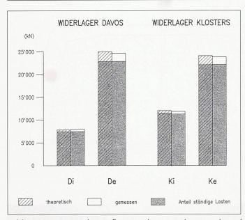
Bild 6. Diagramm der Auflagerreaktionen, theoretisch und gemessen; oberhalb des grauen Bereichs ist der Anteil aus der Laststellung 1 hinzugefügt (Bild 7) (Ing.-büro H. Rigendinger)
