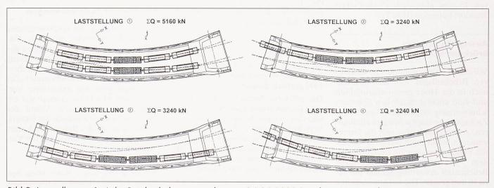
Bild 2. Laststellungen 1–4 der Brückenbelastungsprobe vom 24.04.1993 (Ing.-büro H. Rigendinger)
