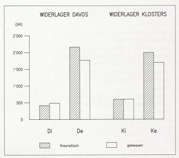
Bild 7. Auflagerreaktionen allein infolge Laststellung 1 (Ing.büro H. Rigendinger)
