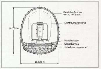
Bild 5b. Konventionell vorgetriebener 1-Spur-Tunnel
