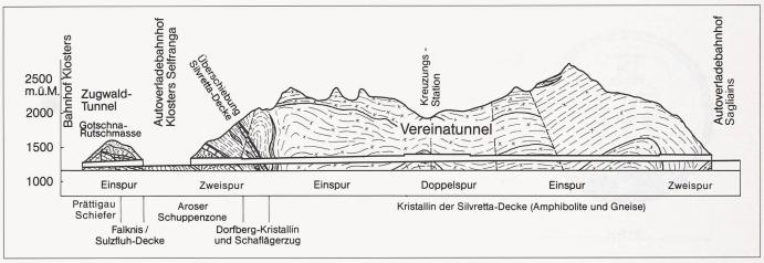
Bild 4 Geologisches Längenprofil
