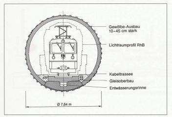
Bild 5a. Mechanisch vorgetriebener 1-Spur-Tunnel
