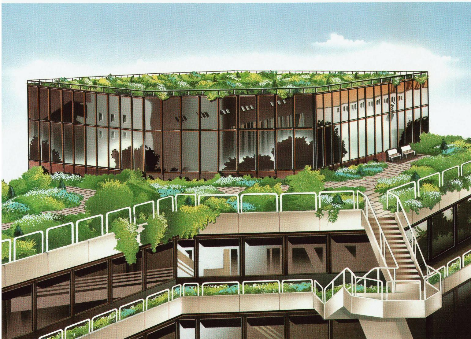
**Styrodur ist der bewährte Wärmedämmstoff für begrünte und bepflanzte Flachdächer.** Das druckfeste Styrodur nimmt kaum Wasser auf, ist alterungsbeständig und bietet deshalb einen dauerhaften Wärmeschutz. Diese besonderen Eigenschaften ermöglichen das Umkehrdachverfahren (UK-Dach). Styrodur wird über der Dachabdichtung verlegt. So wird sie vor mechanischen Einwirkungen
