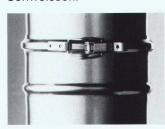
Sicherheit und schnelle Montage mit dem SW-System von SELKIRK. Die Auftulpungen erlauben das schnelle, präzise Ineinanderstecken der Elemente. Dann wird das Sicherheitsklemmband über Sicke und Auftulpung gelegt. Einmal schnapp – und fertig!
