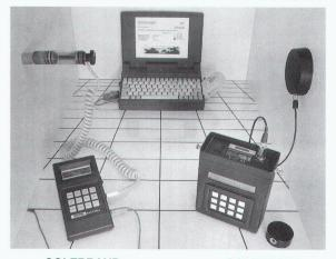
COLEBRAND KORROSION-DETECTOR COLEBRAND BETON DECUMETER
