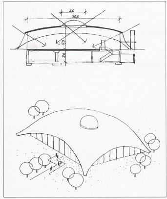
Bild 3. Beispiel – Halle: Tageslichtnutzung einfach und gekonnt. Licht von oben und von der Seite
