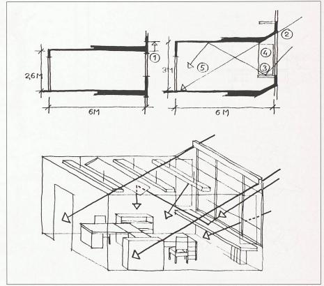
Bild 1. DIANE-Musterraum: Links – Referenzraum; rechts – Musterraum; 1. Raumhöhe; 2. Brüstung angeschrägt; 3. Sims; 4. Seitenwände teilweise transparent; 5. helle Decken, Wände, nicht zu dunkler Bodenbelag
