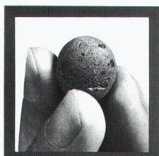
Das Leichtgranulat aus gebranntem Ton
