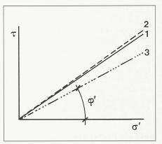
Bild 2. Normalspannung-Scherspannungsdiagramm. Serie 1.1 Sand-Sand, 2 Sand-KDB rauh, 3 Sand-KDB Netzstruktur und Sand-KDB glatt
