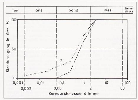
Bild 1. Korngrössenverteilung. Gestrichelt: Sand; punktiert: Sand-Opalitgemisch
